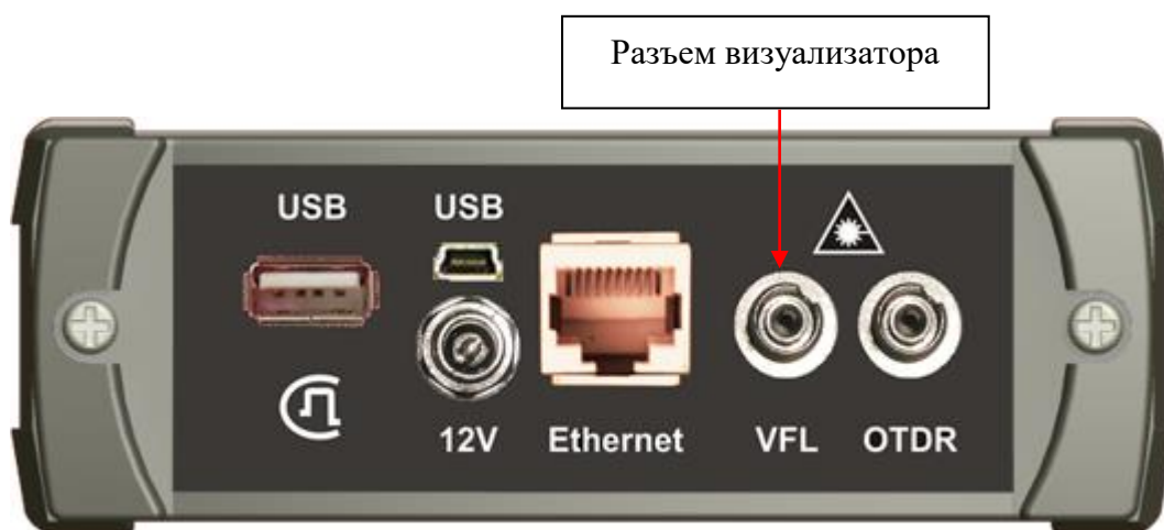
Рис. 66. Подключение ОВ к VFL.
