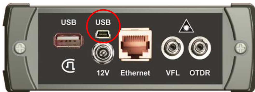
Рис. 94. Разъем mini USB для подключение прибора к ПК.
